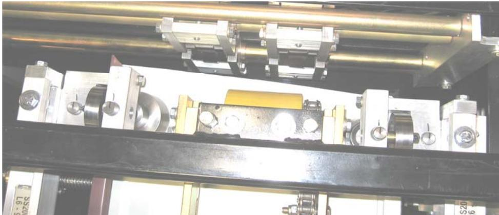
***Ilustración 36: Alineación de Bead Roller***
