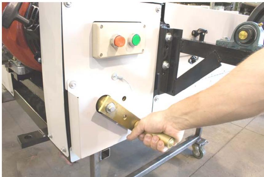
**Ilustración 54: Manija de Ajuste del Carril de Herramientas**
