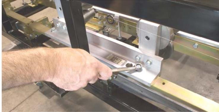
***Ilustración 41: Removiendo Carriles de Herramientas***
