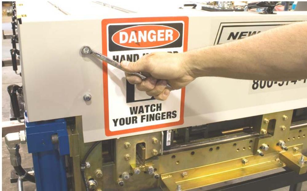
***Ilustración 59: Removiendo la Cubierta de Cizalla***
