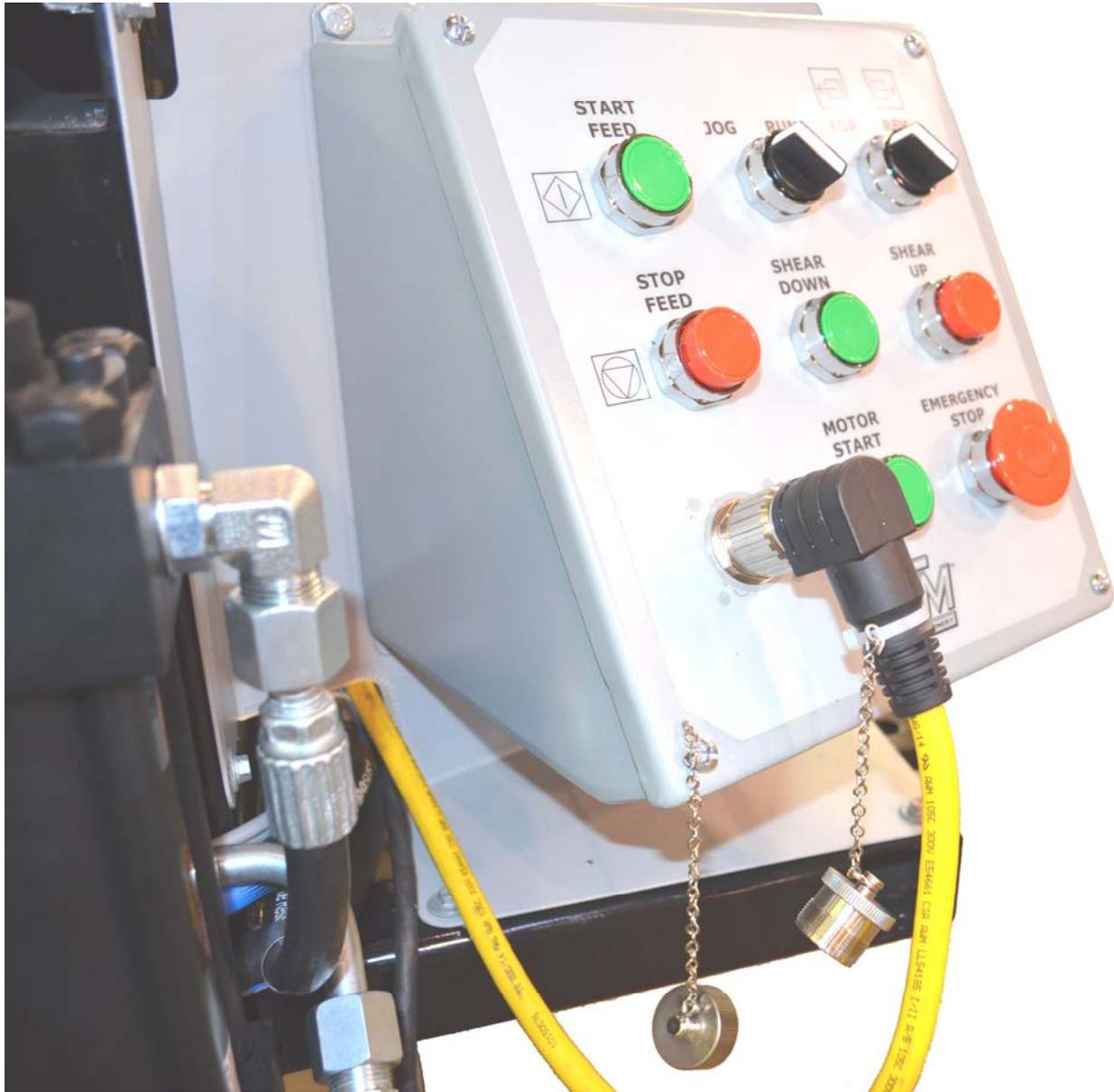
*Ilustración 6: Cable de Control Principal*
